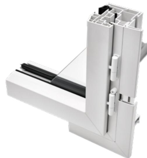
Dormant dépose totale avec tapée rapportée et aile intérieure clipée de 20, 50, 60 ou 80 mm
