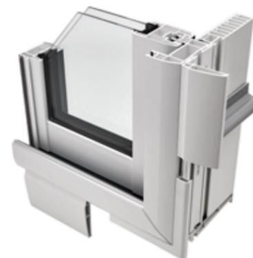
Dormant dépose totale avec tapée rapportée et aile rapportée de 20, 60 ou 80 mm ou dormant rénovation aile rapportée 20, 60 ou 80 mm
