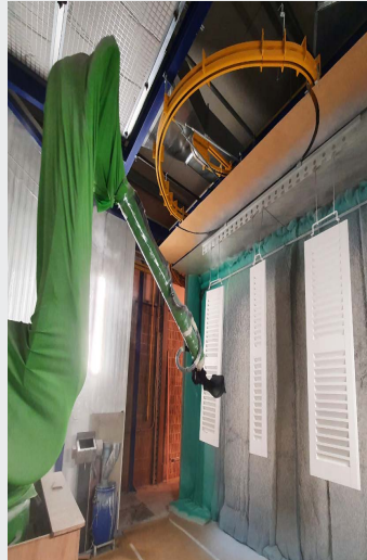
3 COUCHES DE FINITION après un égrenage manuel
