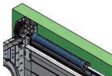
Torsion Avant avec sécurité parachute
