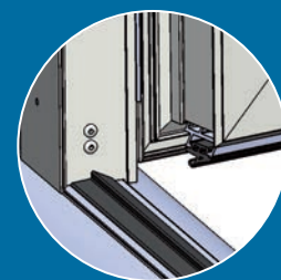
Seuil PMR et son joint d'étanchéité
