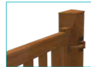
Pose des gonds en applique intérieure, ouverture 180°.
